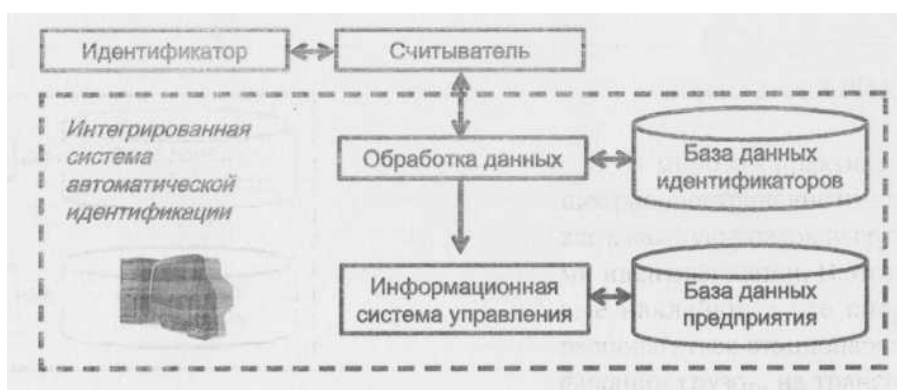
Рис. 5.1.2. Принципиальная схема работы системы автоматической идентификации
