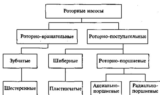
Классификация роторных насосов
