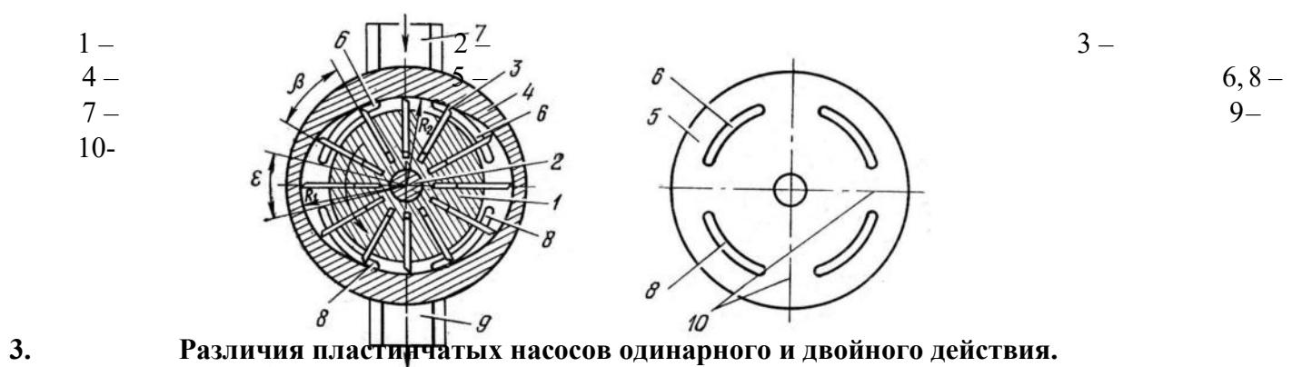
3. Различия пластинчатых насосов одинарного и двойного действия.
