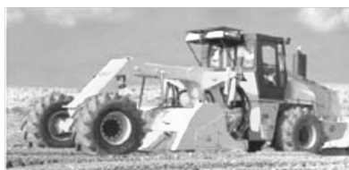
Рис. 62. Дорожные фрезы ДС – 74 и ST 200;
