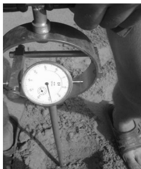
Рис. 41. Ручной пенетromетр РП-1 динамического нагружения
