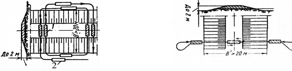
Рис. 29. Схемы движения скрепера при движении по откосу.
