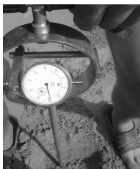
Рис. 41. Ручной пенетрометр РП-1 динамического нагружения
