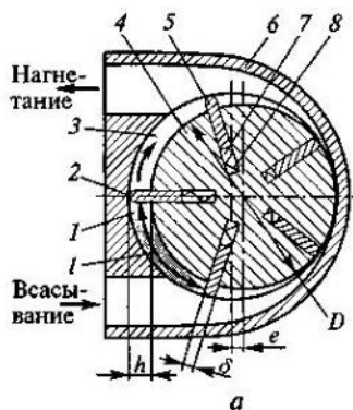
Пластинчатые насосы однократного (а) и двукратного (б) действия:
