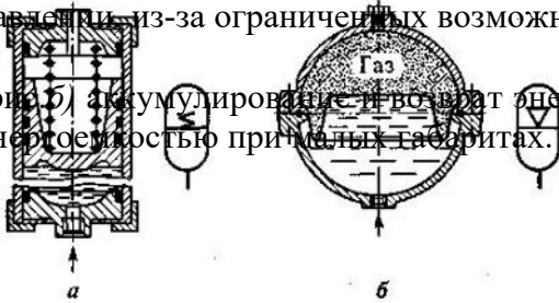
Гидравлические аккумуляторы и их условные изображения: а — пружинный; б — пневматический
